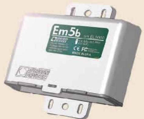
Datalogger diseñado para monitorizar de forma continua los sensores analógicos del sistema ECH<sub>2</sub>O (ver cuadro página 11).
