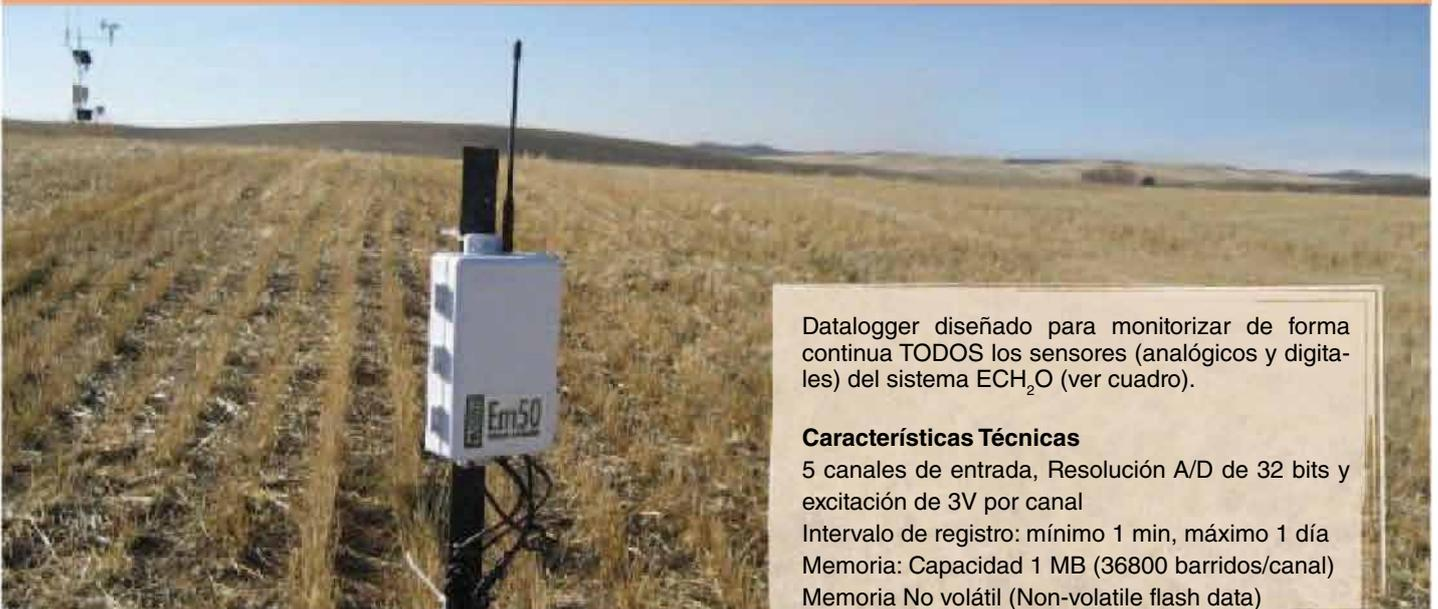
Datalogger diseñado para monitorizar de forma continua TODOS los sensores (analógicos y digitales) del sistema ECH<sub>2</sub>O (ver cuadro).
