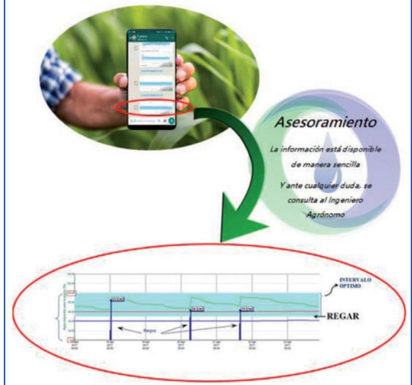
y la línea azul representa los del sensor colocado a 40 cm de profundidad. Las barras azules son los aportes de agua (riego o lluvia). La zona sombreada es el Intervalo Óptimo de humedad del suelo.
