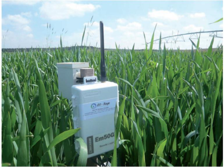
Figura 3. Esquema de un punto de control de la humedad del suelo, con sensores distribuidos a tres profundidades.
